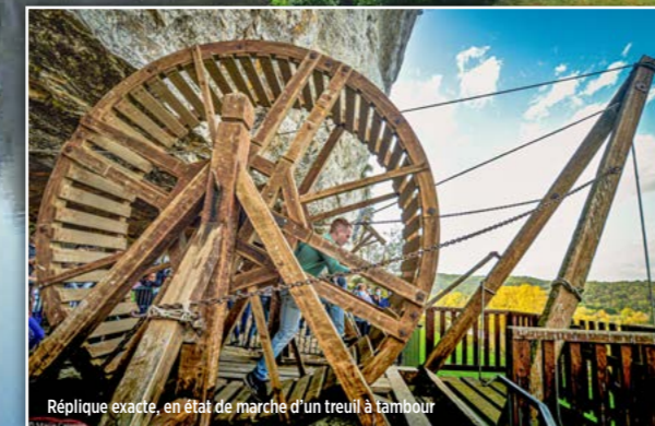
Réplique exacte, en état de marche d'un treuil à tambour
