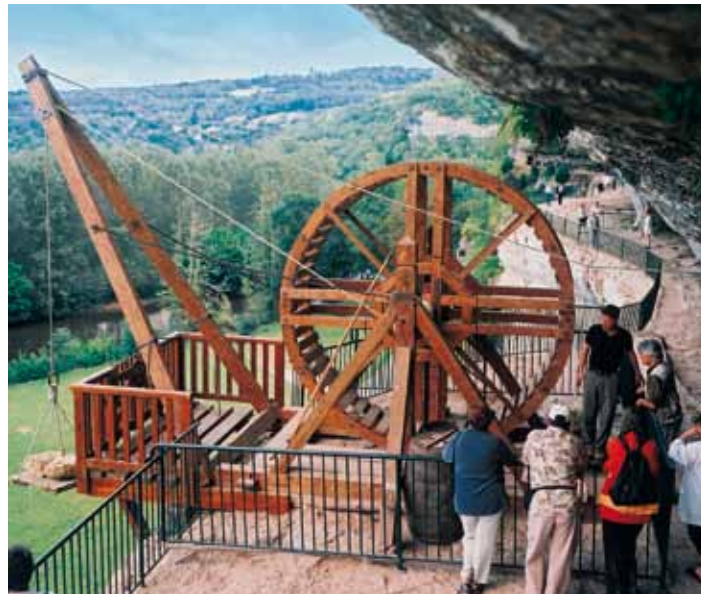
Réplique exacte en état de marche d'un treuil à tambour
